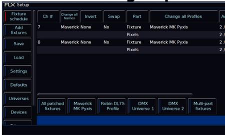
Les groupes de patches des fixtures se trouvent en bas de la liste des fixtures, juste au-dessus de la ligne de **commande bleue**. Ces boutons de groupe de patches sont créés automatiquement et peuvent être utilisés pour filtrer rapidement la liste des fixtures.
