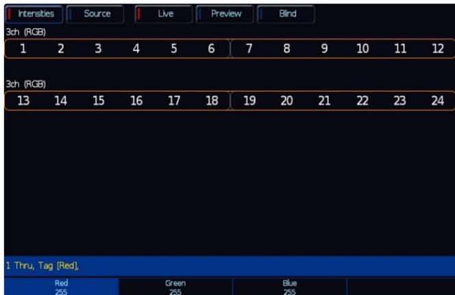
Sélectionnez les fixtures LED sur lesquels vous souhaitez contrôler RVB, mais laissez leur intensité désactivée. La première roue codeuse doit afficher "Rouge". Appuyez sur le nom du paramètre "Rouge" sur l'écran tactile au-dessus de la roue codeuse, et vous devriez voir qu'il passe d'un **arrière-plan bleu foncé** à un **fond bleu clair**.
