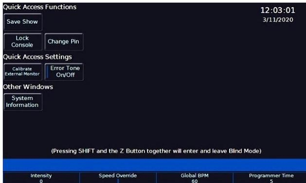
Sur FLX, la fenêtre **Z** contient des fonctions d'accès rapide, des paramètres d'accès rapide, d'autres fenêtres, ainsi qu'une horloge pratique en haut à droite de la fenêtre. Il existe également un bouton «Error Tone On / Off», qui peut être utilisé pour activer / désactiver la tonalité d'erreur intégrée qui peut retentir chaque fois qu'il y a une fenêtre contextuelle, un avertissement ou une erreur.
