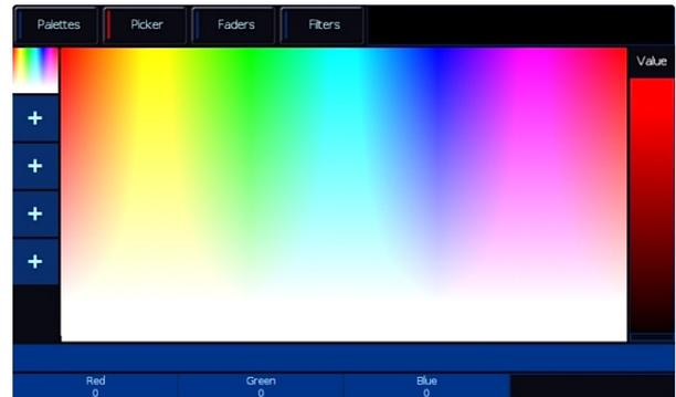
Allumez maintenant les fixtures à pleine intensité. Vous pouvez utiliser la molette d'intensité pour ce faire, en appuyant sur **Z** et en utilisant le premier encodeur. Notez que les fixtures ne s'allumeront pas, car ils sont actuellement noirs.
