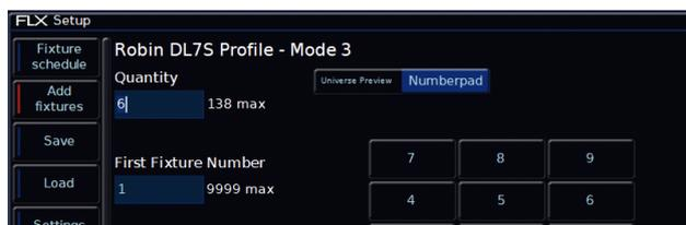
**Le numéro de fixture est le numéro du fader de la console** que vous utilisez pour contrôler l'appareil, et sur FLX, ce sera également le numéro que vous utilisez pour sélectionner cette fixture avec les commandes de syntaxe.
