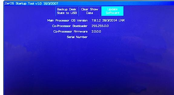
Si vous redémarrez la console et qu'elle ne termine toujours pas le démarrage, une nouvelle installation du logiciel devrait récupérer la console.
