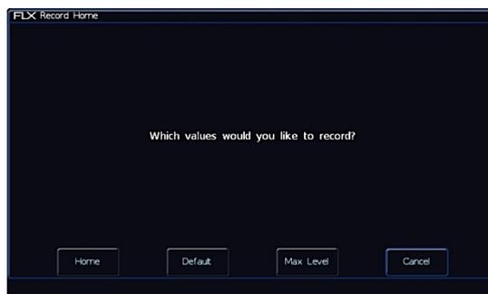
Comme il s'agit d'une commande d'enregistrement normale, cela signifie que les options d'enregistrement normales s'appliquent. Les options d'enregistrement peuvent être ouvertes sur l'écran tactile interne en appuyant longuement sur Enregistrer. Dans la plupart des cas, lors de la personnalisation des valeurs par défaut, vous devrez vous assurer que l'option SmartTag dans les options d'enregistrement est désactivée.
