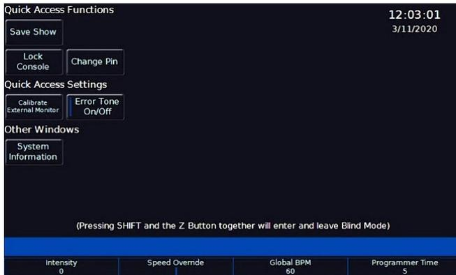
L'option Verrouiller vous permet de verrouiller la console avec un code PIN, de sorte que vous pouvez laisser la console sans surveillance en toute sécurité. Le verrouillage de la console permettra aux Cues de continuer à être lus, et les faders peuvent être utilisés, cependant aucune programmation ou aucun réglage ne peut être ajusté
