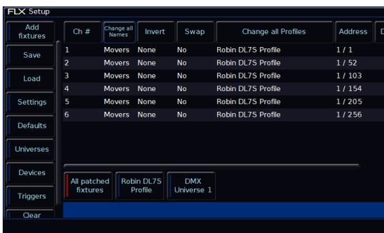
La colonne « Adress » vous permet de configurer les paramètres DMX de vos fixtures. Cela inclut la modification, la suppression et l'ajout d'adresses DMX. L'adresse de départ DMX de chaque fixture sera affichée dans cette colonne, au format **x / y**, où x est le numéro d'univers et y est le numéro d'adresse. Si une fixture n'a actuellement pas d'adresse de départ DMX, la cellule sera laissée vide.
