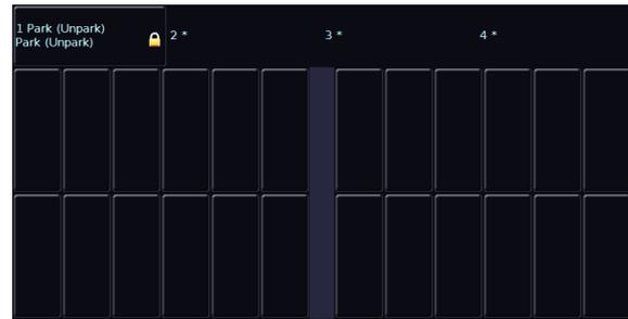
Cet UDK peut ensuite être utilisé pour « Parquer ou déparquer » vos fixtures sélectionnées. "Parquer" est une méthode pour «geler» temporairement la sortie DMX d'une fixture, la «Laisser» dans ses valeurs actuelles. Ni le contrôle manuel, ni les UDK de Cues ou de données de canal ne pourront contrôler les fixtures parquées. Le **Grand Master** et **Blackout** n'affecteront pas non plus une fixture stationnée. Pour reprendre le contrôle, la fixture doit être déparqué.
