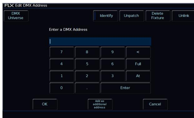
La modification de l'adresse DMX d'une fixture patchée par RigSync mettra à jour l'adresse DMX sur la console et enverra également l'adresse mise à jour à la fixture.
