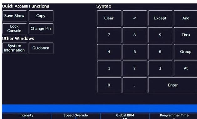
Sur les consoles FLX'S, la fenêtre **Z** contient aussi des fonctions d'accès rapide, d'autres fenêtres et également un pavé numérique de syntaxe à l'écran.
