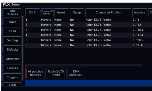
La fonction "**Change Profiles**" peut être utilisée pour modifier une fixture de votre show, en un type différent. Il est utile si une erreur a été commise (par exemple, l'ajout du mauvais modèle ou mode) mais permet également un échange complet d'un type de fixture physiques par un autre, par exemple s'il y a un défaut et que vous ne pouvez pas obtenir un modèle de fixture de remplacement identique.
