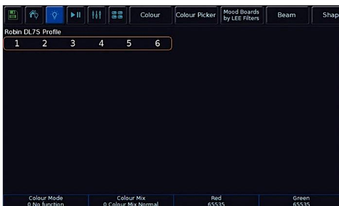
La sélection d'un attribut ouvrira la fenêtre de cet attribut sur l'affichage interne et placera les paramètres de l'attribut sur les quatre roues codeuses, prêts à être contrôlés. L'intensité n'a pas besoin d'un bouton d'attribut, car il est accessible via les faders de canal, l'encodeur de roue d'intensité ( accessible en appuyant sur **Z** ) ou la syntaxe.
