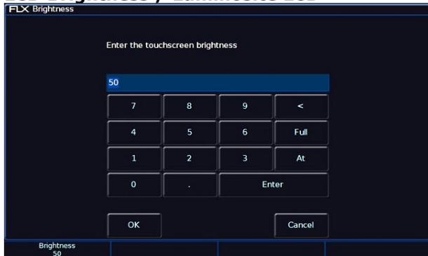
Ces paramètres vous permettent de modifier la luminosité de l'écran interne. La luminosité de l'écran tactile est une valeur comprise entre 0% et 100%. L'utilisation recommandée est à 50% de luminosité. 0% ne permettra pas au rétroéclairage de s'éteindre complètement, mais à un niveau très faible qui peut encore être vu dans la plupart des situations. La première roue codeuse vous permettra de régler cela, ainsi que le pavé numérique à l'écran.
