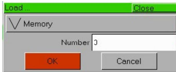
Sélectionner la touche [OK] pour charger la mémoire dans la fenêtre Program. Les niveau de circuits de cette mémoire s'affichent. Maintenant vous pouvez effectuer les modifications souhaitées sur les circuits, par les potentiomètres, ou sur les automatiques. Presser la touche UPDATE. Le moniteur affiche la fenêtre d'options de mise à jour. Sélectionner la touche [OK] pour terminer la modification.
