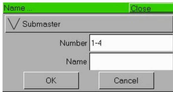
Vous pouvez maintenant utiliser les touches programmables, pour taper le nom du Submaster et presser [OK] pour terminer l'opération. Le nom s'affichera sur le display au dessus du potentiomètre.
